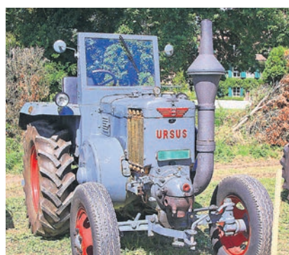
Der polnische Ursus C-45: Ein Nachbau des deutschen Lanz Bulldog D 9506
